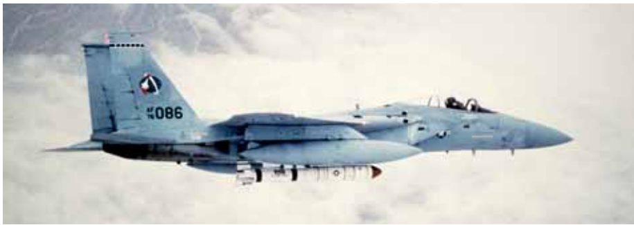
Una ripresa dell'F-15 EAGLE utilizzato durante i test del missile ASAT ASM-135, visibile agganciato al pilone centrale.
