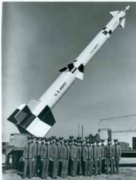
Un gruppo di cadetti dell'accademia militare di West Point in visita al poligono di White Sands di fronte ad un missile NIKE ZEUS. Su questo si possono notare i 3 stadi del missile, evidenziati dalle scacchiere bianco-nera.
