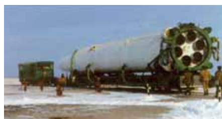
Trasporto mediante ferrovia dedicata del vettore TSIKLON-2 (11K69) al pad di lancio, con il satellite IS già installato a bordo
