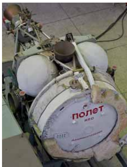
Il simulacro di un satellite POLYOT in esposizione presso il museo della MPO Mashinostroyeniya. Si può notare la mancanza dell'antenna frontale del radar (assente su questa versione) e i serbatoi sferici alternati agli ugelli dei motori per le manovre in orbita.
