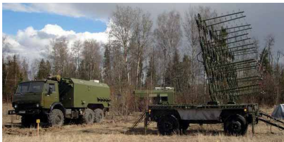
Il sistema da guerra elettronica TIRADA, destinato a contrastare i satelliti da comunicazione americani e operativo nella seconda metà degli anni ottanta. A sinistra l'autocarro con i trasmettitori radio, a destra il rimorchio con le antenne elicoidali.
